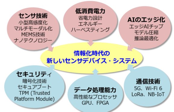
図6. 情報化時代のセンサ・センシング技術に求められる要素技術
