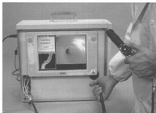
図5 内視鏡挿入訓練用力覚付きバーチャル内視鏡システム。大腸鏡の挿入訓練を患者個別のMRIデータを用いて実施可能。
